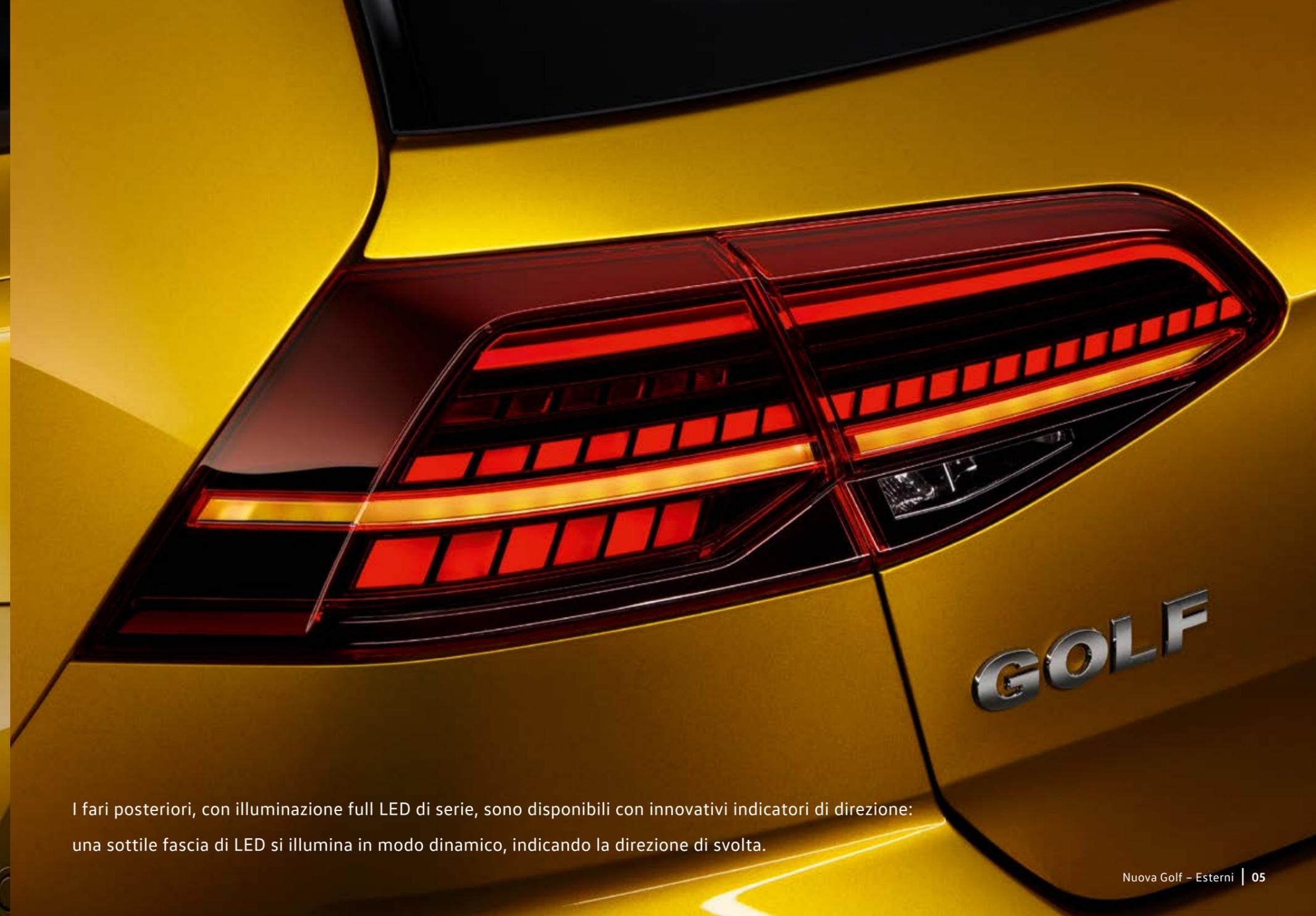
I fari posteriori, con illuminazione full LED di serie, sono disponibili con innovativi indicatori di direzione: una sottile fascia di LED si illumina in modo dinamico, indicando la direzione di svolta.
